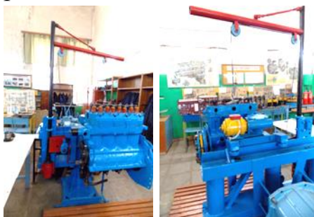
Рисунок-1 Разработанный стенд с двигателем от трактора Д240
