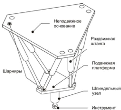
Рисунок 1 - Станок на базе механизма с параллельной кинематикой - "Гексапод".
